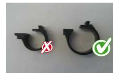
Essendo un running-change, vedere di utilizzare solo il collarino grande (01-3205)
