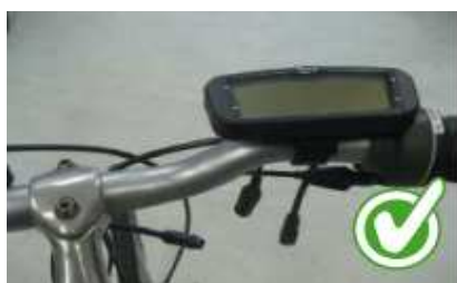
Montare la console vicino alla manopola/cambio.
